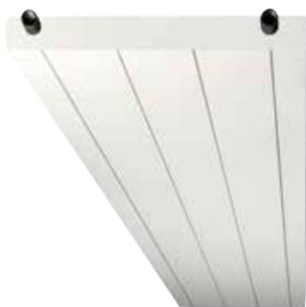
Le système INFRA AQUA DESIGN est un panneau radiant aluminium alimenté en eau chaude, équipé de façon standard d'une couche isolante en laine de verre, qui empêche les pertes de chaleur vers le haut. Ce système permet de chauffer un espace sans déplacement d'air. Par ailleurs, seule la zone ciblée est chauffée. Grâce à un préchauffage rapide et une température ambiante réduite, INFRA AQUA DESIGN permet de réaliser d'importantes économies d'énergie.
