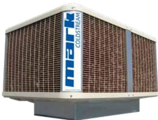
Le Mark ColdStream avec refroidissement adiabatique est basé sur l'évaporation de l'eau du robinet. La chaleur requise pour cela est extraite de l'air extérieur. L'air frais extérieur passe à travers les filtres en cellulose mouillés par l'eau. L'évaporation de l'eau du robinet réduit la température de l'air d'une manière naturelle et écologique.
