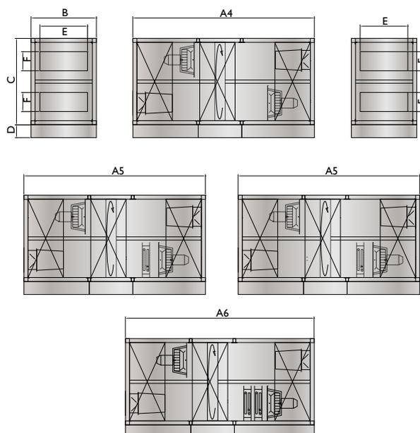
Airstream HWX avec prise d'air extérieur et clapet de recirculation\*
