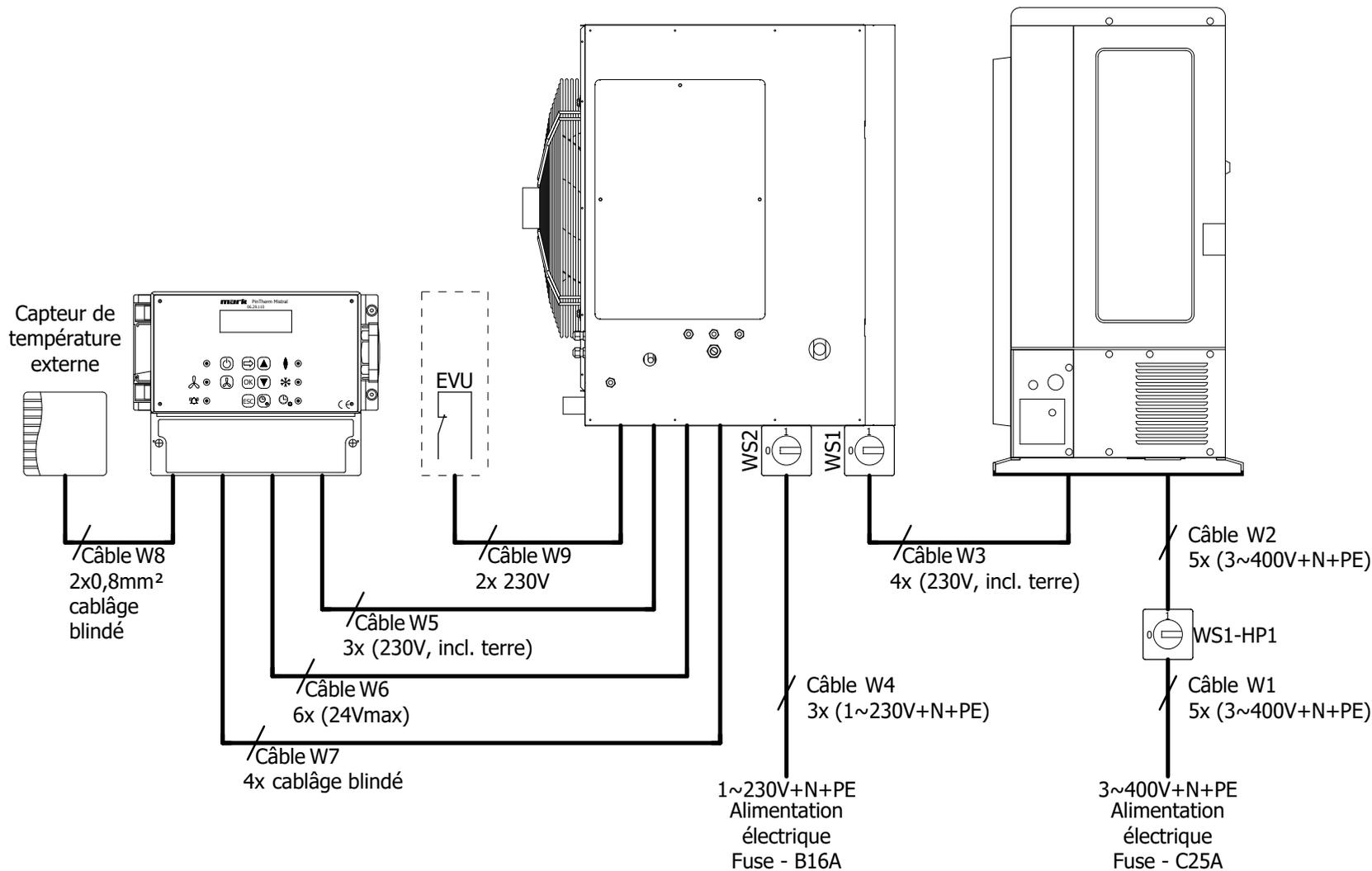
WS1/WS2 - L'interrupteur de proximité monté sur l'unité intérieure
